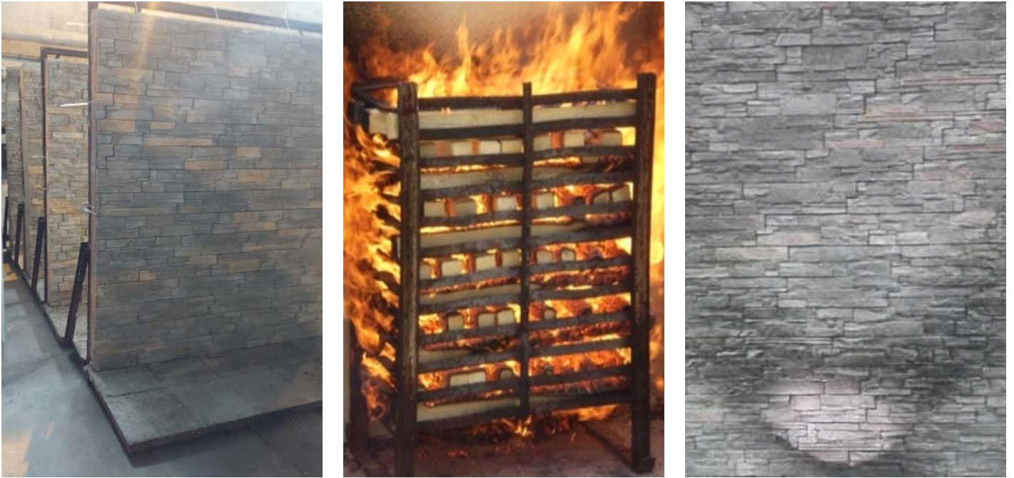
Fig. 1 Ensayos de reacción al fuego Tests for reaction to fire
